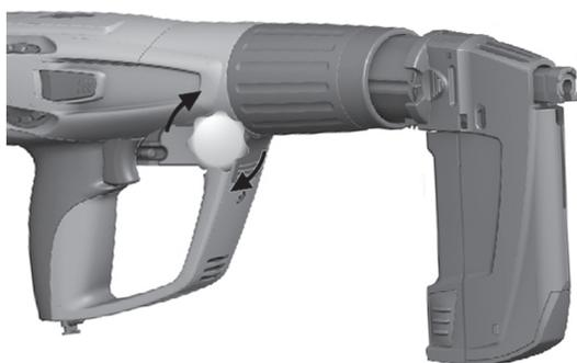
Fixer l'appareil au moyen l'étrier de retenue et en serrant la vis moletée.
