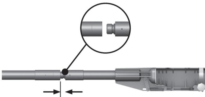
Visser ensemble le tube et le manchon puis les tirer à la force de la main et sans outil auxiliaire.
