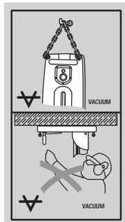
Em cima: para perfurações horizontais com fixação por vácuo, a coluna não pode ser utilizada sem um dispositivo de segurança adicional.
