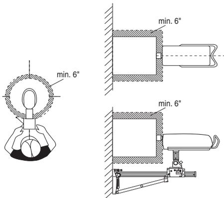
A área a tracejado define a área de perigo do dispositivo de perfuração. Durante o funcionamento, mantenha uma distância mínima de 15 cm (6") da coroa de perfuração.
