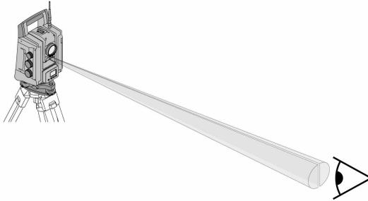
L'assistance de guidage consiste en un orifice de sortie sur la lunette, duquel sort respectivement à la moitié, une lumière verte et une lumière rouge.
