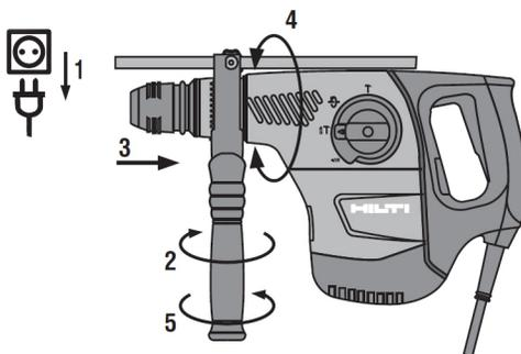
1. Drehen Sie am Griff, um die Halterung (Spannband) des Seitenhandgriffs zu lösen.
