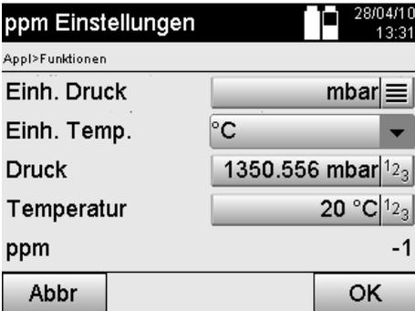
2. Wählen Sie die entsprechenden Einheiten und geben Sie Druck und Temperatur ein.
