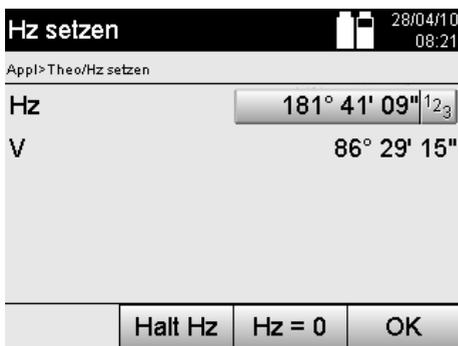
**Hz = 0** Aktuellen Hz-Winkel auf 0 setzen.
