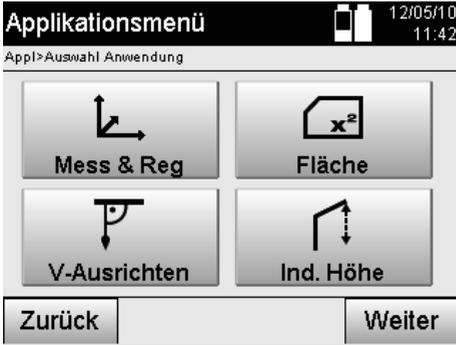
Nach Aufruf der Applikation wählen Sie zwischen Fläche in der horizontalen oder vertikalen Ebene.
