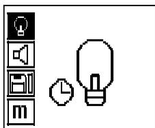
Éclairage d'arrière-plan automatique. Cette option désactive automatiquement l'éclairage de l'arrière-plan après 5 minutes si aucune touche n'est pressée et il est à nouveau activé lorsqu'un bouton est enfoncé.
