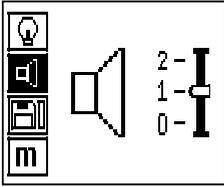
Réglage du volume sonore du signal acoustique lors de la mesure. Utiliser les boutons fléchés pour atteindre les options individuelles. Sélectionner l'option souhaitée à l'aide du bouton de confirmation et appuyer sur le bouton d'annulation pour revenir au menu des paramètres.
