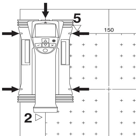
Placer le scanner au point de départ indiqué par la flèche clignotante. Veiller à ce que les repères d'alignement sur le scanner soient alignés correctement avec le quadrillage de référence comme illustré ci-avant.
