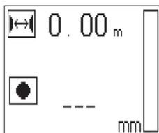
La distance entre les fers peut être automatiquement calculée à l'aide de la fonction Détection à balayage rapide (Quickscan) au cours de laquelle le point central des fers est cherché et le bouton d'enregistrement rouge enfoncé à l'aplomb du centre de la position. Le point central des fers suivant est alors cherché et le bouton d'enregistrement à nouveau enfoncé. La distance entre les fers est automatiquement enregistrée et reprise.
