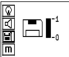
Pour supprimer, appuyer sur le bouton fléché indiquant vers le bas puis sur le bouton de confirmation, ou appuyer sur le bouton d'annulation pour retourner au menu des paramètres.
