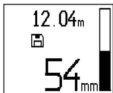
Pour enregistrer la position et la profondeur de toutes les armatures métalliques détectées, appuyer le scanner contre la surface et, à l'aide de la détection à balayage rapide (Quickscan), chercher un endroit ne contenant pas de fer. Marquer le point de départ à l'aide d'un crayon de marquage PUA 70 et appuyer sur le bouton d'enregistrement. Le symbole disquette apparaît à l'écran signifiant que le scanner enregistre les données. Déplacer le scanner sur la surface.
