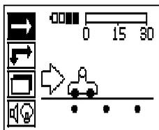
Mettre le scanner en marche. En premier lieu, le symbole à balayage rapide (Quickscan) est automatiquement sélectionné.
