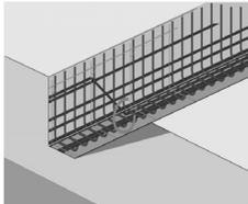
Dans les cas où l'armature ne doit pas être endommagée, veiller à effectuer des scannages avec imagerie (Imagescan) sur au moins trois côtés de la structure afin de repérer également les fers porteurs (les fers disposés dans un angle dans le béton).
