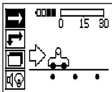
La capacité de mémoire restante pour l'enregistrement du scannage rapide (Quickscan) est affichée en haut de l'écran (selon le type d'appareil et l'unité de mesure réglée) en mètres ou en pieds.
