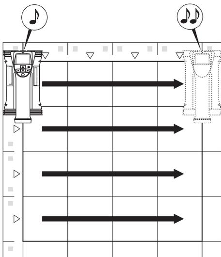
Le scanner émet un double bip à la fin de la ligne et arrête automatiquement l'enregistrement. Répéter ce processus pour chaque ligne et chaque colonne et surveiller à l'écran les invites.
