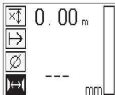
Le mode de mesure Balayage rapide (Quickscan) avec détermination précise de la profondeur peut être sélectionné en appuyant sur le bouton de confirmation.
