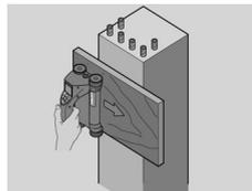
Utiliser un support d'appui fin non métallique (ex. en bois, polystyrène expansé, carton...) dépassant de l'/des arête(s) de la structure et scanner le support au-delà de l'arête. Ne pas omettre de soustraire l'épaisseur du support des valeurs de mesure de profondeur. La valeur
