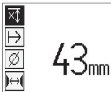
Sélectionner la fonction mesure de profondeur limitée à l'aide des boutons fléchés et appuyer sur le bouton de confirmation.
