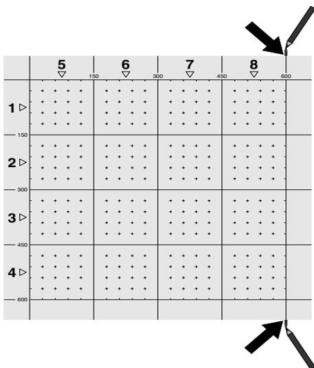
Fixer le quadrillage de référence comme pour un scannage avec imagerie (Imagescan). Marquer les bords ou les trous d'écartement aux extrémités de tout quadrillage de référence par lequel s'effectue le transfert vers le quadrillage suivant à l'aide d'un crayon de marquage PUA 70. Fixer au mur tous les autres quadrillages de référence requis, afin que les bords coïncident.
