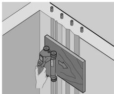
Les surfaces rugueuses (par ex. surfaces de béton avec un agrégat visible) provoquent trop de parasites dans le signal, ainsi, sous certaines conditions, la profondeur et le diamètre d'un fer d'armature ne peuvent pas être déterminés. Dans un tel cas, le scannage sur un support d'appui fin peut également être efficace. Tenir également compte du conseil ci-dessus sur la soustraction de l'épaisseur du support.
