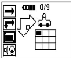
Mettre le scanner en marche et, à l'aide des boutons fléchés, sélectionner le symbole à scannage rapide (Quickscan) dans le menu principal. L'état de charge des accus est affiché avec le nombre maximum de 9 scannages avec imagerie (Imagescan) se trouvant en ce moment dans la mémoire.
