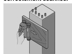
Utiliser un support d'appui fin non métallique (ex. en bois, polystyrène expansé, carton...) dépassant de l'/des arête(s) de la structure et scanner le support au-delà de l'arête. Ne pas oublier de soustraire l'épaisseur du support des valeurs de mesure de profondeur. La valeur
