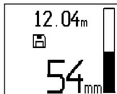
Para registrar la posición y la profundidad de todos los hierros de armadura detectados, coloque el escáner sobre la superficie y busque un lugar en el que no haya hierros bajo la superficie mediante la detección Quickscan. Marque el punto inicial con un lápiz marcador PUA 70 y pulse la tecla de registro. En la pantalla aparece un símbolo de disquete que significa que el escáner está registrando los datos. Desplace el escáner por encima de la superficie.
