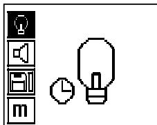
Retroiluminación automática. Con esta opción, la retroiluminación se apaga si pasan 5 minutos sin accionar ninguna tecla y se enciende de nuevo al volver a pulsar una tecla.
