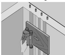
Les surfaces rugueuses (par ex. surfaces de béton avec un agrégat visible) provoquent trop de parasites dans le signal, ainsi, sous certaines conditions, la profondeur et le diamètre d'un fer d'armature ne peuvent pas être déterminés. Dans un tel cas, le scannage sur un support d'appui fin peut également être efficace. Tenir également compte du conseil ci-dessus sur la soustraction de l'épaisseur du support.
