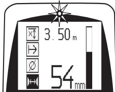
Le fer d'armature repose sur la ligne médiane du scanner et peut être marqué à la surface à l'aide d'un crayon de marquage PUA 70. La précision de la mesure de profondeur peut être augmentée, si le diamètre de fer d'armature approprié est entré ou en choisissant le mode de mesure avec détermination précise de la profondeur (voir 7.2.5.2)
