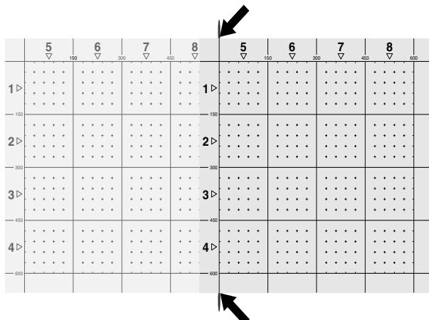
Seleccione la posición del siguiente Imagescan y repita el proceso de escaneo. Los Imagescans ejecutados se pueden repetir simplemente seleccionando la zona que se pretende escanear y ejecutando el proceso de Imagescan. Los datos se sobrescribirán. Si ya se han grabado todos los Imagescans o si se ha alcanzado el máximo de 9 registros, pulse una vez la tecla de cancelación para volver al menú principal. Para representar y analizar los datos, transfíralos al monitor (véase 7.4.1).
