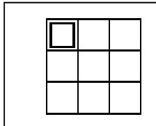
Une représentation du scannage par bloc (Blockscan) apparaît. Chaque carré représente un scannage avec imagerie (Imagescan). Jusqu'à 3x3 scannages avec imagerie (Imagescan) peuvent être scannés. Sélectionner la position du premier scannage avec imagerie (Imagescan) souhaité à l'aide des boutons fléchés. Appuyer sur le bouton de confirmation pour commencer le premier scannage avec imagerie (Imagescan). Attention, les coordonnées de chaque point sont reportées dans le coin en haut à gauche.
