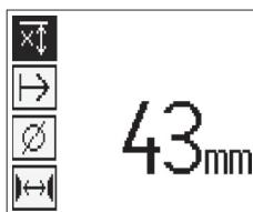
Seleccione a função da medição limitada da profundidade com as teclas de seta e prima a tecla de confirmação.
