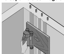
Las superficies irregulares (p. ej., superficies de hormigón en las que se ven los remates) generan interferencias en la señal de modo que, bajo ciertas circunstancias, no se puede determinar la profundidad o el diámetro de unos hierros de armadura. En estos casos es recomendable escanear a través de una superficie de apoyo fina. La indicación superior relativa a restar el espesor de la superposición también es válida en este caso.
