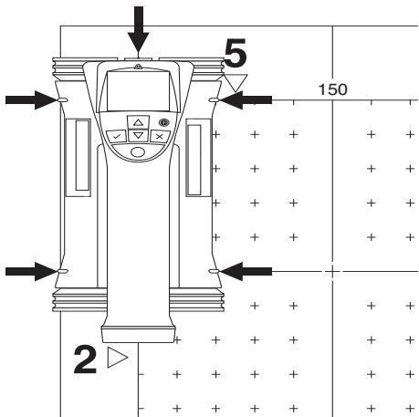
Coloque el escáner en el punto inicial indicado por la flecha parpadeante. Compruebe que las marcas de orientación del escáner se han orientado correctamente respecto a la cuadrícula de referencia, tal como se mostraba anteriormente.
