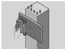
Utilize uma superfície de apoio não metálica (por ex., madeira, esferovite, papelão,...) que sobressaia da(s) aresta(s) da estrutura e leia a superfície de apoio para lá da aresta. Não esquecer de subtrair a espessura da superfície de apoio dos valores da profundidade medidos. O valor pode ser introduzido no software para PC, sendo em seguida subtraído automaticamente de todos os valores da profundidade medidos.
