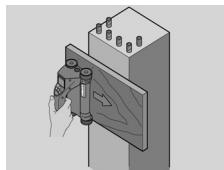
Utilice un recubrimiento fino no metálico (p. ej., madera, poliestireno, cartón, etc.) que sobresalga por el borde de la obra y escanee el recubrimiento por fuera del borde. No olvide restar el espesor del recubrimiento a los valores de medición obtenidos para la profundidad. Puede introducirse el valor en el software del PC y este se resta automáticamente de todos los valores de medición de profundidad.
