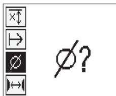
Se nenhum diâmetro do ferro for seleccionado, o Scanner calcula a profundidade como se se tivesse ajustado o diâmetro médio da respectiva gama normalizada de ajustes.
