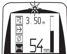
O ferro da armadura encontra-se ao longo da linha central do Scanner e pode ser marcado na superfície utilizando um marcador PUA 70. A precisão da medição de profundidade pode ser aumentada, quando se introduz o diâmetro correcto dos ferros da armadura ou mudar para o modo de medição com determinação precisa da profundidade (consultar 7.2.5.2).
