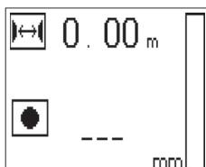
A distância entre ferros pode ser calculada automaticamente utilizando a função detecção Quickscan procurando o ponto central do ferro e premindo a tecla de registo vermelha por cima do centro da posição. A seguir procura-se o próximo ponto central do ferro e prime-se novamente a tecla de registo. A distância entre ferros é guardada e assumida automaticamente.
