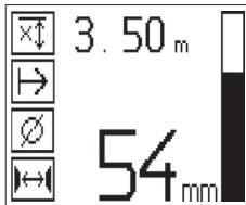
Après réglage du diamètre et de la distance entre les fers, le processus de scannage est identique à la détection à balayage rapide (voir 7.2.5.1).
