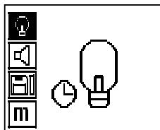
Luz de fundo automática. Esta opção desliga a luz de fundo passados 5 minutos se não se accionar qualquer tecla e volta a ligá-la logo que se accionar uma.
