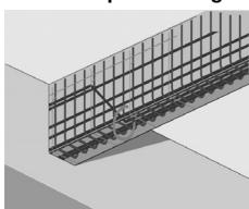
Nos casos em que não se pode danificar a armadura, assegurar-se de que se executam Imagescan em pelo menos três lados do componente para que os ferros transversos (dispostos obliquamente no betão) possam ser detectados.
