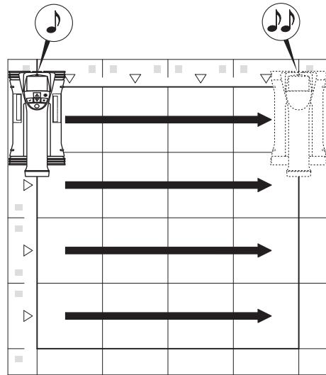
O Scanner emitirá dois sinais acústicos breves no fim da linha, parando automaticamente o registo. Repita este processo para cada linha e coluna, observando os comandos no visor.
