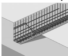
Si la armadura no puede dañarse, asegúrese de realizar Imagescans en al menos tres lados de la pieza, para que los hierros de empuje (los que están dispuestos en el hormigón de manera angular) se puedan detectar.
