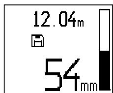
Para registar a posição e profundidade de todos os ferros da armadura detectados, coloque o Scanner na superfície e utilize a detecção Quickscan para procurar uma posição onde não há ferros por baixo. Marque o ponto de partida com um marcador PUA 70 e prima a tecla de registo. O símbolo de disquete surgirá no visor indicando que o Scanner está a registar dados. Desloque o Scanner sobre a superfície.
