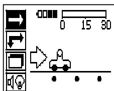
La capacidad restante de la memoria para el registro Quickscan se muestra en la parte superior de la pantalla (según el modelo de la herramienta y la unidad de medida seleccionada) en metros o pies.
