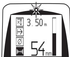
El hierro de armadura se encuentra en la línea central del escáner y se puede marcar en la superficie con un lápiz marcador PUA 70. La precisión de la medición de profundidad puede incrementarse si se introduce el diámetro correcto de los hierros de armadura o si, en el modo de medición, se cambia con determinación exacta la profundidad (véase 7.2.5.2).
