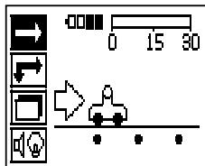
A capacidade de armazenamento restante para o registo Quickscan é apresentada na parte superior do ecrã em metros ou pés (consoante o tipo de ferramenta e unidade de medição ajustada).
