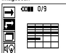
El número de Imagescans en el escáner, hasta un máximo de 9, se indica en la parte superior de la pantalla.
