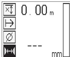
Premindo a tecla de confirmação selecciona-se o modo de medição Quickscan com determinação precisa da profundidade.
