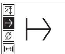
Seleccione la dirección de escaneo deseada y pulse la tecla de confirmación.
