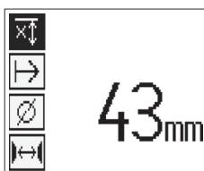
Sélectionner la fonction mesure de profondeur limitée à l'aide des boutons fléchés et appuyer sur le bouton de confirmation.
