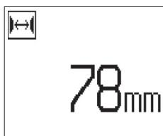
En caso de conocerse la distancia se puede introducir el valor de forma manual mediante las teclas de dirección.
