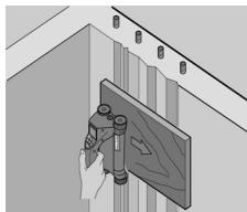
Superfícies irregulares (por ex., superfícies de betão onde o agregado está visível) geram interferências adicionais no sinal, de modo que, em determinadas circunstâncias, não é possível determinar a profundidade ou o diâmetro de um ferro de armadura. Nestes casos também é vantajoso fazer a leitura através de uma tábua de apoio delgada. Também se aplica aqui a indicação acima relativa à subtração da espessura da tábua.
