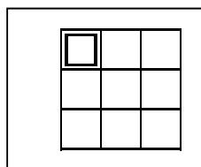
Aparecerá una representación del Blockscan. Cada cuadrado representa un Imagescan. Se pueden escanear hasta 3 x 3 Imagescans. Utilice las teclas de dirección para seleccionar la posición del primer Imagescan previsto. Pulse la tecla de confirmación para comenzar con el primer Imagescan. Debe tener en cuenta que las coordenadas de cada punto se refieren a la esquina superior izquierda.
