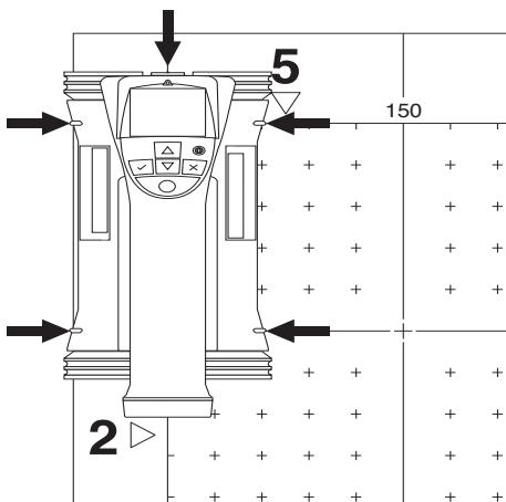
Coloque o Scanner no ponto de partida indicado pela seta a piscar. Certifique-se de que as marcas de orientação no Scanner, como se mostra acima, estão correctamente alinhadas com a grelha de referência.
