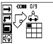
Conecte el escáner y, en el menú principal, seleccione el símbolo de Blockscan con ayuda de las teclas de dirección. El estado de carga de la batería se muestra junto con el número máximo de 9 Imagescans que se encuentren en la memoria en ese momento.
