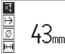
Seleccione con las teclas de dirección la función de medición de profundidad restringida y pulse la tecla de confirmación.
