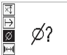
Si aucun diamètre d'armature n'est sélectionné, le scanner calcule la profondeur comme si le diamètre d'armature moyen de la série de normes correspondante avait été réglé.
