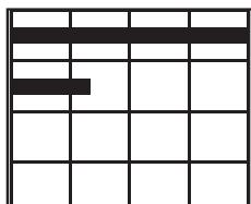
Prima a tecla de registo e desloque o Scanner ao longo da primeira linha. O progresso da leitura é representado através de um linha preta larga que avança no visor à medida que o Scanner se desloca sobre a superfície.
