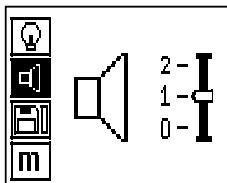
Ajuste el volumen de la señal acústica al realizar mediciones. Utilice las teclas de dirección para acceder a las distintas opciones. Seleccione la opción deseada mediante la tecla de confirmación y pulse la tecla de cancelación para regresar al menú de configuración.
