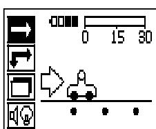
Conecte el escáner. De forma automática se selecciona en primer lugar el símbolo de Quickscan. En el menú principal, seleccione la función Quickscan mediante la tecla de confirmación.
