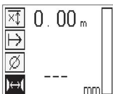
El modo de medición Quickscan con determinación exacta de la profundidad se selecciona pulsando la tecla de confirmación.
