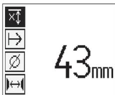
Επιλέξτε με τα πλήκτρα με βέλη την περιορισμένη λειτουργία μέτρησης βάθους και πατήστε το πλήκτρο επιβεβαίωσης.
