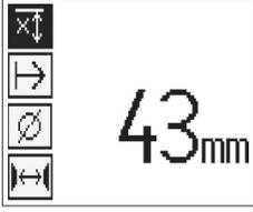
Ok tuşları ile, sınırlandırılan derinlik ölçümü fonksiyonu seçilmeli ve onay tuşuna basılmalıdır.
