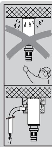
A utilização do sistema colector de água permite que esta seja drenada da coroa, evitando assim sujar a área circundante ao furo. Atingem-se melhores resultados se for utilizado um aspirador a húmido em conjunto.
