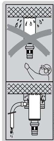
É obrigatória a utilização de um sistema colector de água em conjunto com um aspirador quando se utiliza em perfurações no tecto.
