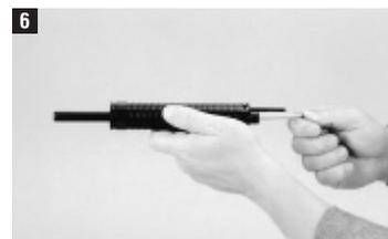
Вытолкните поршень из направляющей с помощью шомпола.
