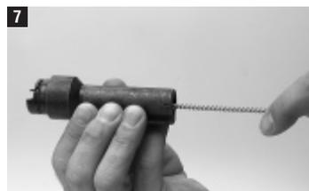
7 Чистка внутренней части направляющей крепежного элемента..
