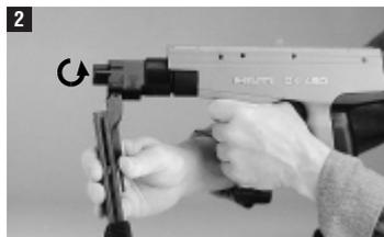
Вывинтить опорную пластину.
