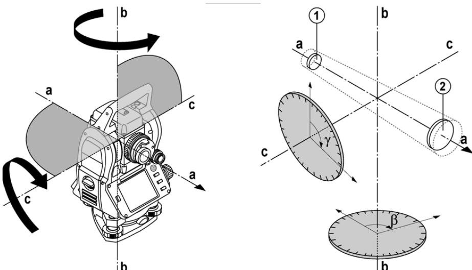
Con ayuda de niveles electrónicos (compensadores) se calculan las inclinaciones de las herramientas y se corrigen las lecturas de los círculos; además se calculan la distancia inclinada, la distancia horizontal y la diferencia de altura medidas.
