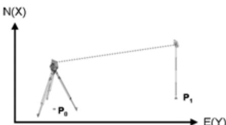
La position de l'appareil se situe sur un point de coordonnée **P0** et vise un autre point de coordonnée **P1** à des fins d'orientation.
