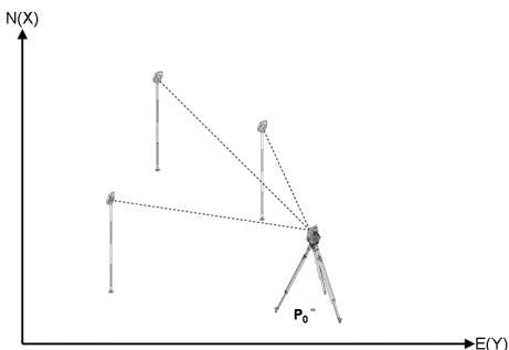
P0 es la posición de la herramienta después del emplazamiento.
