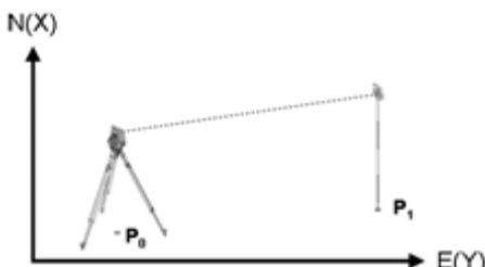
La posición de la herramienta se encuentra sobre un punto de coordenadas **P0** y apunta a otro punto de coordenadas **P1** para realizar la orientación.
