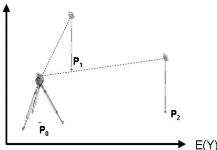
La posición de la herramienta se encuentra sobre un punto libre **P0** y mide sucesivamente los ángulos y las distancias respecto de los puntos de referencia provistos de coordenadas **P1** y **P2**.
