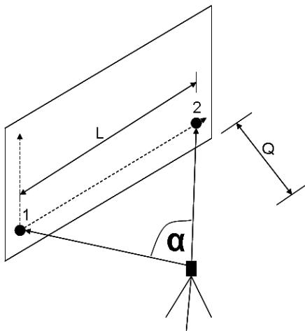
Une configuration resp. position de l'appareil optimale est alors établie lorsque le rapport entre la longueur horizontale de référence  $L$  et la distance  $Q$  est de l'ordre de  $L : Q = 25 : 10$  à  $7 : 10$ , de sorte que l'angle inclus soit compris entre  $\alpha = 40^\circ$  et  $100^\circ$ .
