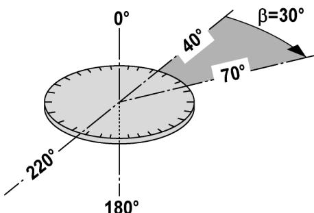
El ángulo encerrado de  $70^\circ - 40^\circ = 30^\circ$  puede calcularse a partir de las lecturas del círculo horizontal medidas con un ángulo de  $70^\circ$  con respecto al objetivo y un ángulo de  $30^\circ$  con respecto al otro objetivo.
