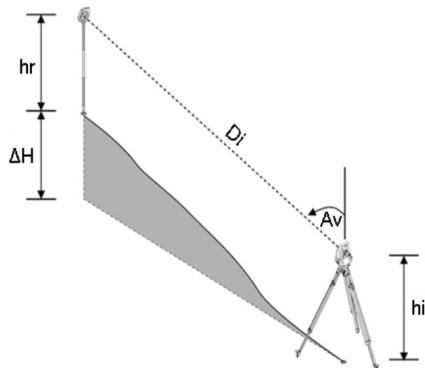
Les mesures de hauteurs sont calculées à l'aide de l'**angle vertical** et de la **distance inclinée** en rapport avec la hauteur de l'instrument **hauteur de l'instrument** et la **hauteur du réflecteur**.
