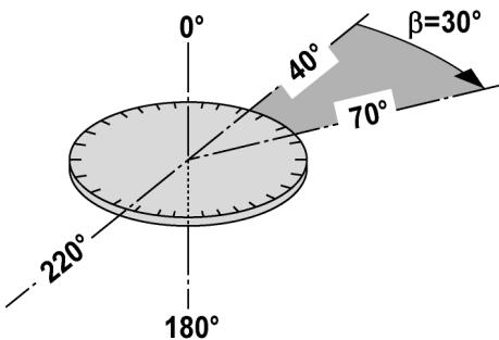
A partir das leituras horizontais medidas do limbo ( $70^\circ$  até um alvo e  $30^\circ$  até ao outro alvo) pode calcular-se o ângulo incluído  $70^\circ - 40^\circ = 30^\circ$ .
