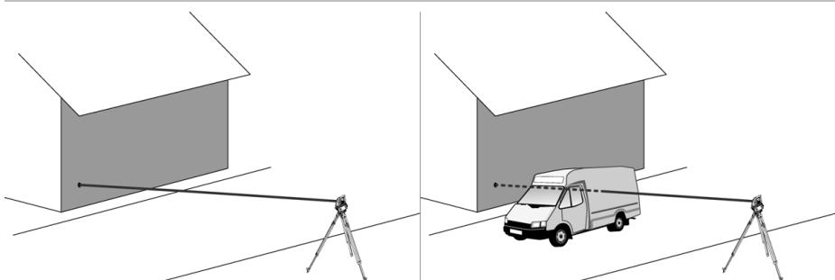
Com o raio medidor é possível efectuar medições a qualquer alvo fixo.
