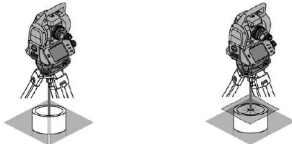
Coloque sobre el tubo un papel, una lámina o cualquier otro material ligeramente transparente para visualizar el punto del láser.
