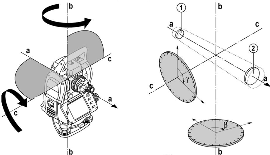
Com ajuda dos níveis electrónicos (compensadores) são determinadas inclinações da ferramenta e corrigidas as leituras do limbo bem como calculadas a distância horizontal e desníveis a partir da distância inclinada medida.
