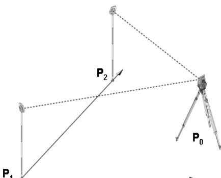
La position **P<sub>0</sub>** de l'appareil n'est pas au niveau de la ligne de construction. La mesure par rapport au premier point de référence **P<sub>1</sub>** définit le début de la ligne de construction, tandis que le second point de référence **P<sub>2</sub>** permet de relever la direction de la ligne de construction dans le système de l'appareil.
