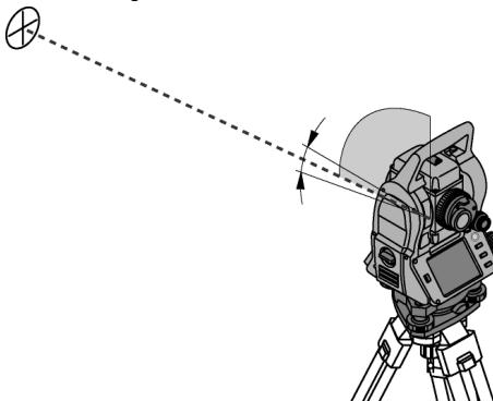
5. Sélectionner une cible clairement identifiable à  $\pm 3$  degrés par rapport à l'horizontale à une distance de 70-120 m env. et viser avec précaution.
