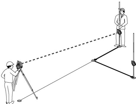
**P0** es la posición de la herramienta después del emplazamiento.
