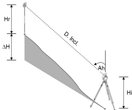
Medições de alturas são calculadas com ajuda do **Ângulo Vertical** e da **Distância inclinada** em conjunto com a **Altura do instrumento** e a **Altura do reflector**.
