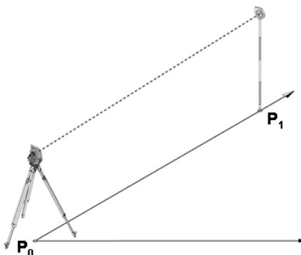
La position **P0** de l'appareil et le point d'orientation **P1** se situent sur une ligne de construction commune.
