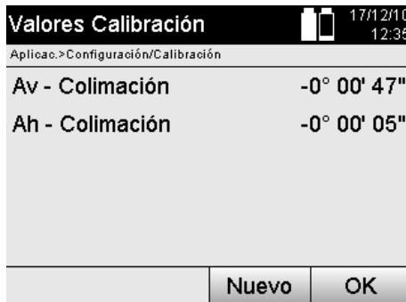
4. Inicie el proceso de calibración o confirme los valores de calibración indicados y prescinda de realizar otra calibración.
