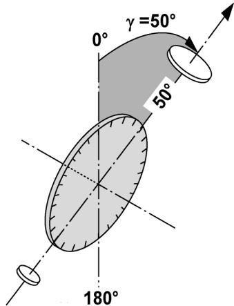
Étant donné que le cercle vertical est orienté à  $0^\circ$  par rapport au sens de la gravité ou à  $0^\circ$  par rapport à la direction horizontale, l'angle est ainsi quasiment défini à partir du sens de la gravité.
