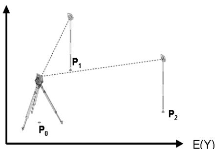
La position de l'appareil se situe sur un point libre **P0**, puis les angles et distances sont successivement mesurés à deux points de référence **P1** et **P2** définis par coordonnées.
