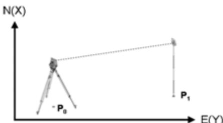
A posição da ferramenta encontra-se sobre um ponto de coordenadas **P0** e aponta, para orientação, para um outro ponto de coordenadas **P1**.
