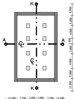
Généralement, avant le début du chantier, l'entreprise en charge du métrage marque d'abord des repères de hauteur et lignes de construction à l'intérieur et sur le pourtour du périmètre de construction.
