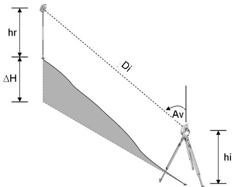
Las mediciones de altura se calculan con ayuda del **ángulo vertical** y la **distancia inclinada** en combinación con la **altura del instrumento** y de la **altura del reflector**.
