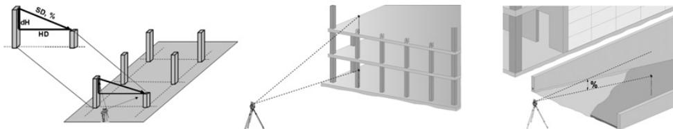
Pour déterminer une inclinaison à l'aide de la ligne manquante
