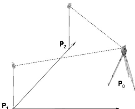
La posición de la herramienta **P0** está fuera de la línea de referencia. La medición respecto del primer punto de referencia **P1** establece el inicio de la línea de referencia, mientras que el segundo punto de referencia **P2** sirve para determinar la dirección de la línea de referencia en el sistema de la herramienta.
