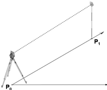
La posición de la herramienta **PO** y el punto de orientación **P1** están situados en una línea de referencia común.
