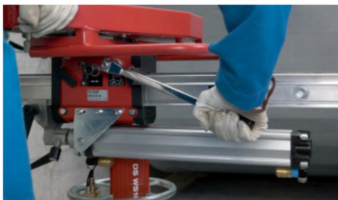
Placer et serrer le boulon de serrage dans le sens des aiguilles d'une montre puis installer la butée d'extrémité.
