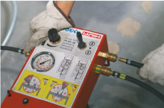
Raccorder les conduites d'air comprimé au compresseur et au boîtier de commande (DS WS10).
