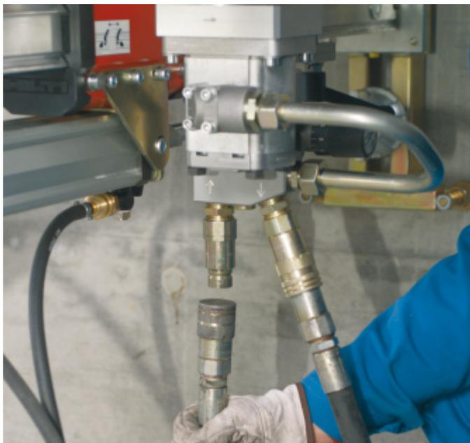
Raccorder les conduites hydrauliques à au bloc-moteur (DS WS10).
