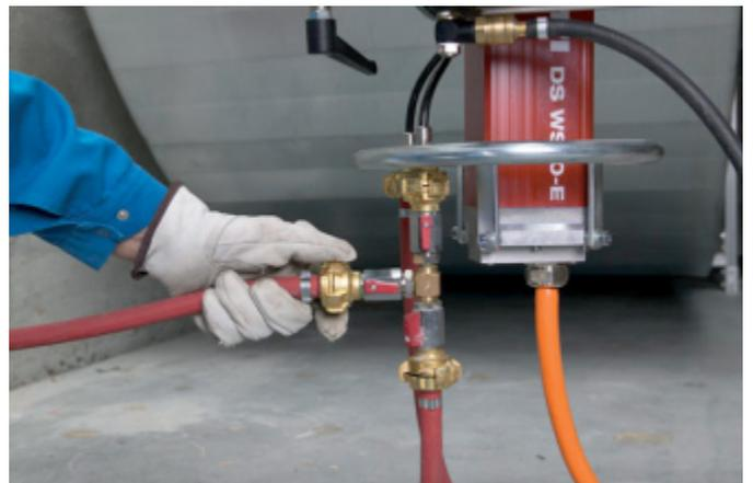
Raccorder le raccord d'eau au bloc-moteur (DS WS10-E). Raccorder au répartiteur les flexibles à eau pour les lances d'alimentation en eau froide (DS WS10-E).
