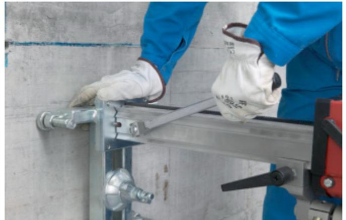
Serrer le boulon d'excentrique dans le sens des aiguilles d'une montre.
