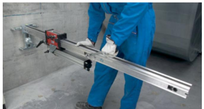
Installer l'extension de stockage et la bloquer à l'aide du boulon d'excentrique.
