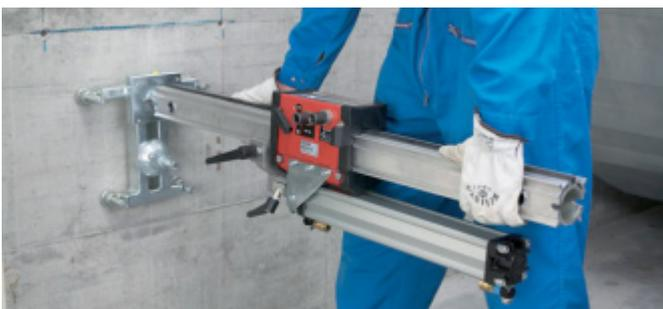
Enficher le cône de positionnement dans la glissière de guidage et introduire entièrement le boulon d'excentrique.
