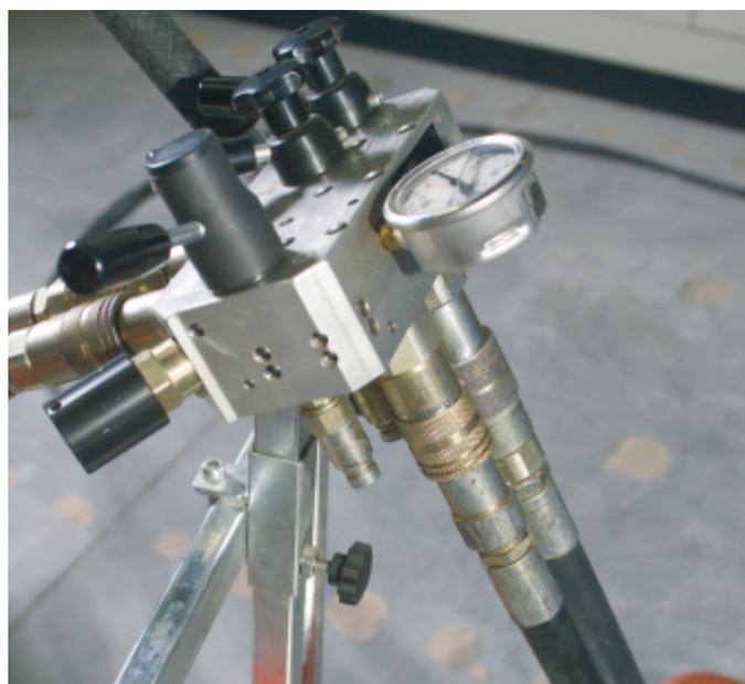
Raccorder les conduites hydrauliques au bloc de distribution et de régulation / groupe hydraulique (D-LP15 / D-RC22 ou D-LP32).
