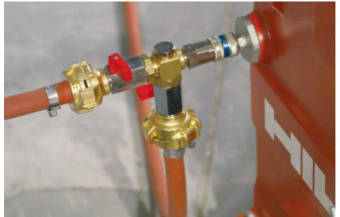
Monter un répartiteur d'eau sur le groupe hydraulique (DS WS10).
