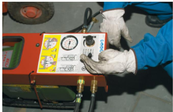
Actionnement de la commande d'avance (DS WS10)
