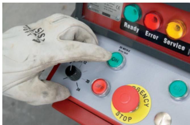
Mettre le mécanisme d'entraînement principal DS WS10-E en marche et laisser le câble diamant démarrer.
