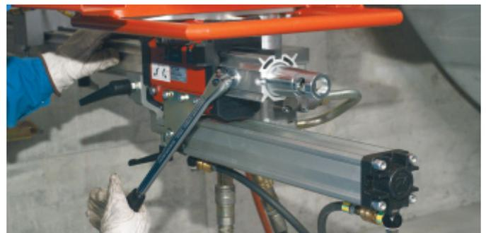
Enficher le cône de jointure et le bloquer à l'aide du boulon d'excentrique.
