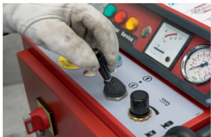
Actionnement de la commande d'avance (DS WS10-E)
