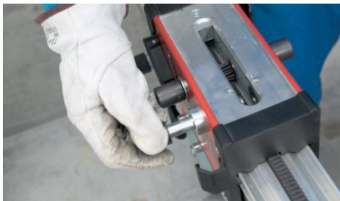
Retirer le boulon de serrage de l'étrier de guidage.
