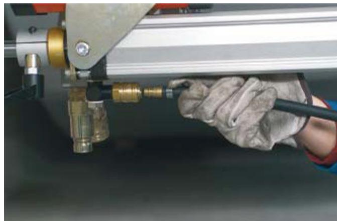
Conecte las mangueras de aire comprimido al cilindro.
