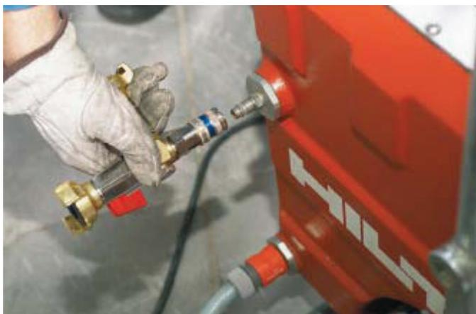
Ajuste la conexión de tres vías
