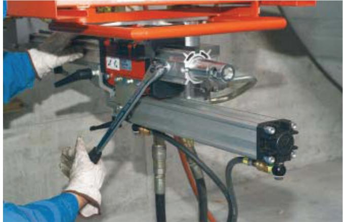
Ajuste el cono de conexión y asegúrelo con el bulón excéntrico.
