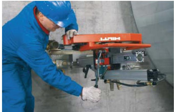
Empuje hasta el fondo las palancas y apriételas girando en dirección de las agujas del reloj. Acople el tope final.
