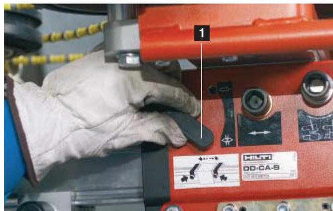
**1** Avance la palanca de bloqueo del movimiento.
