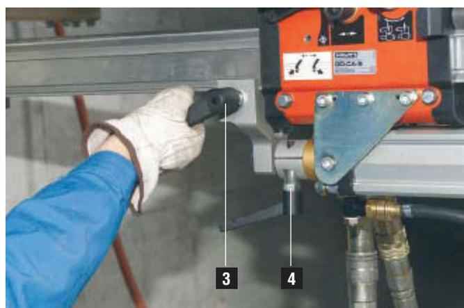
Después apriete la palanca de la barra de pistón, coloque y apriete el cierre del retorno y entonces desacople la palanca de bloqueo del movimiento de impulsión.
