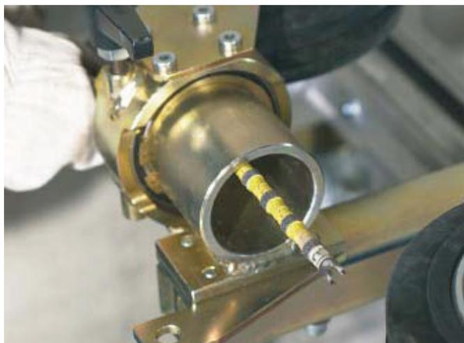
Meta el hilo a través de los ejes huecos del pie de poleas ( si se usa) y después a través de los ejes huecos de la barra transversal hueca de la sierra de hilo compacta. Para verificar que el hilo se gasta de forma pareja y sigue estando redondo, recomendamos que, antes de conectar los extremos, se haga girar el hilo en la dirección contraria a la de las agujas del reloj, (aproximadamente un giro o giro y medio por cada metro de longitud).
