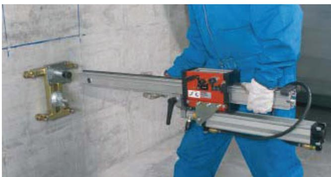
Empuje el rail guía hasta el cono de conexión e inserte completamente el bulón excéntrico.
