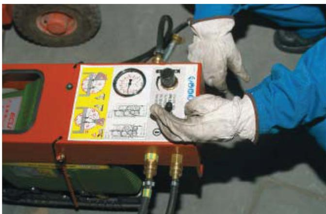
Maneje la válvula de control de impulsión.
