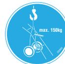
ソーヘッドとアクセサリーのトロリーをクレーンで搬送する場合は、必ず指定されたサポートポイントのところで持ち上げてください。搬送の際には、トロリーに取り付けられたすべてのパーツが動いたり落下したりしないようにしっかりと固定してください。クレーンの吊り上げ領域には絶対に立ち入らないでください。テスト済みの承認されたリフトツールとベルトを使用してください。
